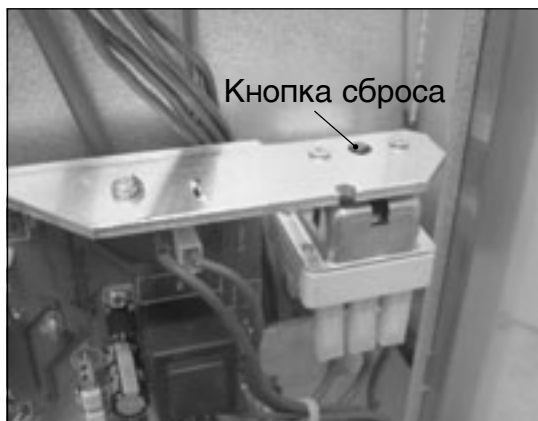
Рис. 3. Защита от перегрева
